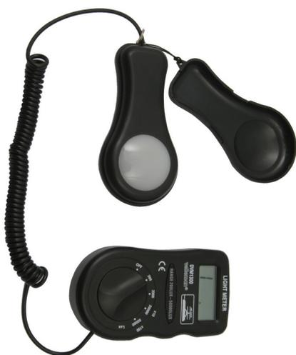
Un **luxmètre** est un capteur permettant de mesurer l'intensité lumineuse.
