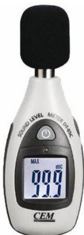
Un **sonomètre** est un instrument destiné à mesurer le niveau de pression acoustique, une grandeur physique liée au volume sonore.
