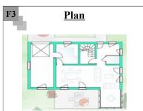
Réalisé à la main ou par ordinateur, il contient des symboles normalisés et utilise une échelle.
