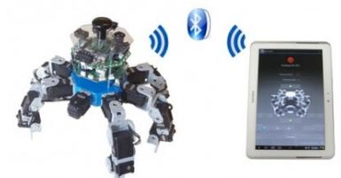
Il modifie son comportement en fonction des informations transmises par ses capteurs et un signal extérieur (signal bluetooth d'un smartphone).
