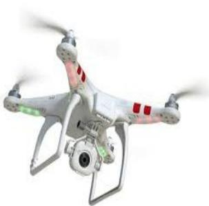
Il modifie son comportement en fonction des informations transmises par ses capteurs pour se stabiliser et exécute les ordres reçus par la télécommande
