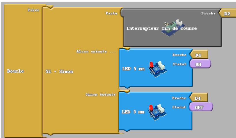
→ **SI** un obstacle appuie sur l'interrupteur fin de course branché sur le port D2,
